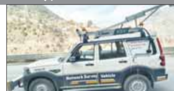
सड़कों पर मौजूद गड़कों, दरारों और अन्य खामियों की सटीक पहचान कर उनकी निगरानी करेंगे। सूचना मिलने पर इन अवरोधों की समय-समय पर
